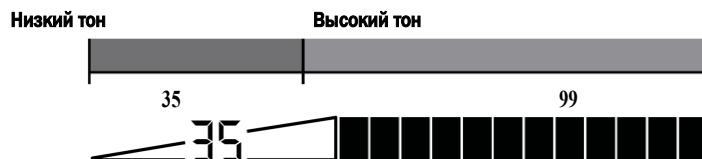
Функция IRON AUDIO: в Неселективном режиме железные объекты с отметкой менее 35 теперь дают слышимый отклик с добавочным низким тоном, а металлические объекты, не содержащие железа, дают чистый тон средней чистоты.
