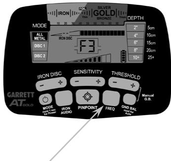
Кнопка регулировка частоты FREQ
