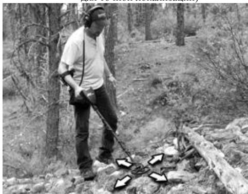
**Примечание:** Для достижения наилучших результатов при использовании способа точной локализации сохраняйте постоянную высоту катушки над поверхностью земли (например, 2 см) и проверяйте, что металлоискатель правильно отстроен от грунта.
