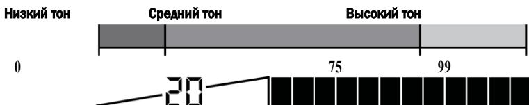
Функция IIRON AUDIO включена: Теперь для объектов с отметкой менее 20 слышен звуковой сигнал низкого тона, а для объектов с отметкой выше 20 – звуковой сигнал среднего или высокого тона.
