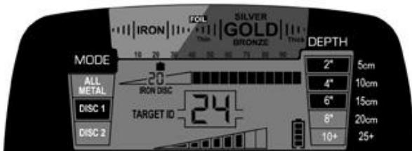
На этом рисунке *AT Gold* работает в режиме **DISC 1** с параметром **IRON DISC**, равным 20. Гвоздь, показанный на иллюстрации 1 (на стр. 21), на шкале Цифровой отметки объекта регистрируется между 18 и 24. Чтобы исключить гвоздь из числа обнаруживаемых объектов, кнопкой **IRON DISC** (+) увеличьте уровень дискриминации железа до 24.
