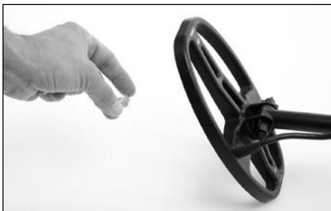
Для воздушного теста поместите катушку на ровную, устойчивую неметаллическую поверхность в нескольких метрах от других металлических объектов.
