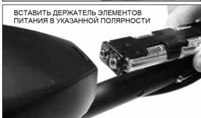
Крышка отсека питания снимается поворотом против часовой стрелки на четверть оборота. Возьмите держатель элементов питания за верх и низ и вытащите их, выдвинув прямо вдоль оси. Для замены элементов питания сдвиньте лоток
