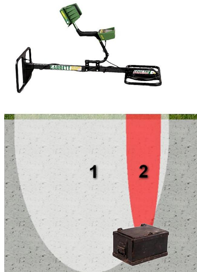
Локализация найденного объекта осуществляется при нажатой и удерживаемой кнопке **TREASURE IMAGING**. При этом задняя излучающая катушка отключается, а передняя катушка начинает работать как стандартная приемно-передающая поисковая катушка 15". Подробнее о режиме Локализации см. 8.3.
