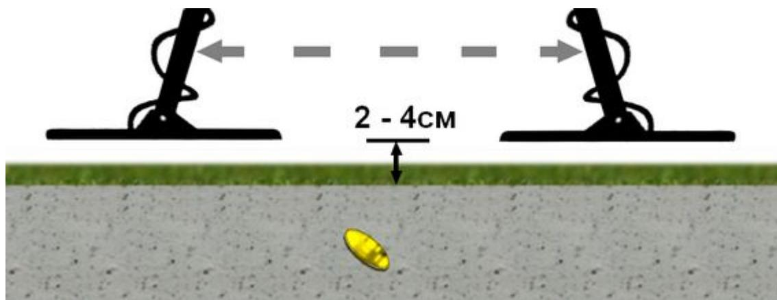
Каждый последующий взмах должен перекрывать предыдущий на половину размера катушки (подобно змейке). Таким образом избегаются пропуски на максимальной глубине.
